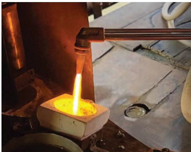
Figura 11 Quema del amalgama de mercurio y oro y liberación de vapores de mercurio en la Amazonía.
