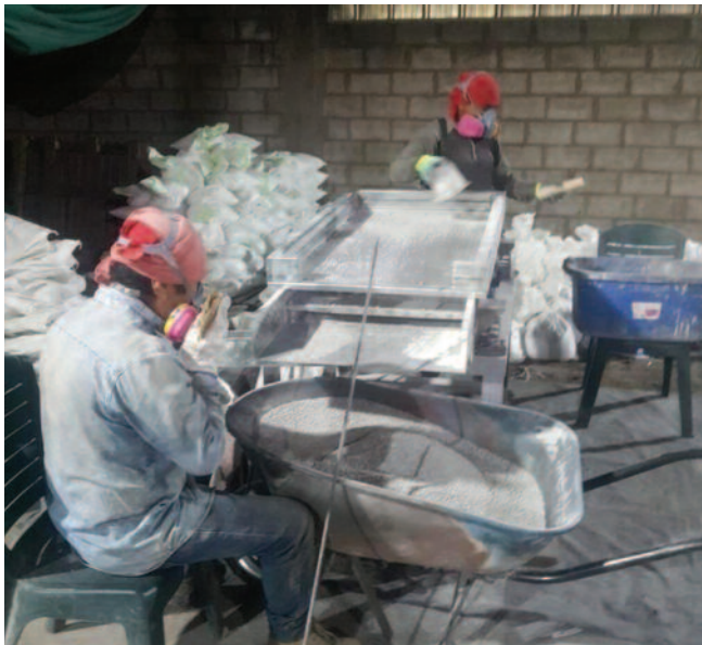
Figura 27 Procesamiento de grava con mercurio: filtrado (izquierda) y lavado (derecha).
